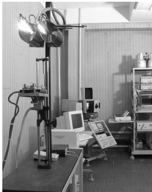
Рис. 2. Установка для испытаний и сертификации фотопреобразователей
