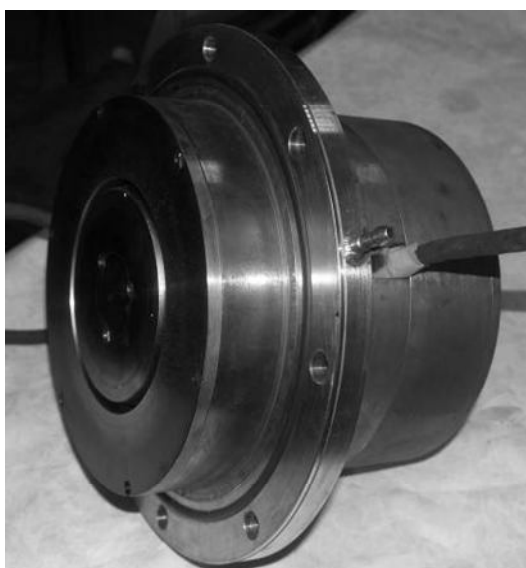
Рис. 1. Опытный образец ускорителя с анодным слоем для предварительной очистки поверхности
