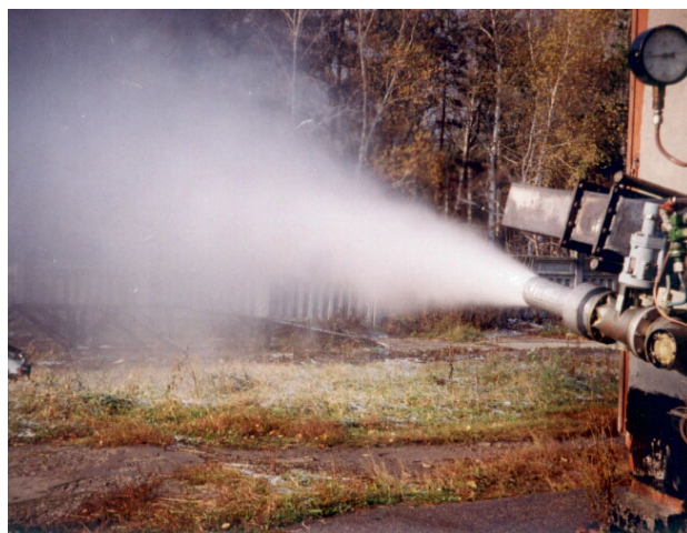
Рис. 11. Распыление биопрепарата, содержащего нефтеокисляющие бактерии, с использованием «холодного сопла» двигателя АИ-9В
