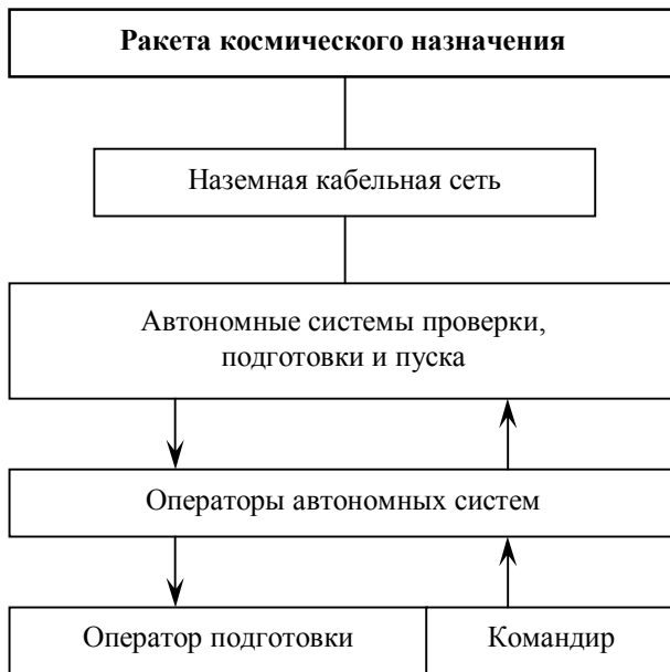
Рис. 1. Структура наземного проверочно-пускового оборудования ракеты космического назначения «Союз»
