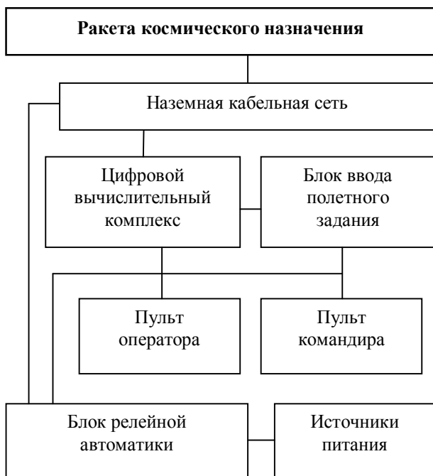
Рис. 3. Структура наземного проверочно-пускового оборудования современных ракет космического назначения
