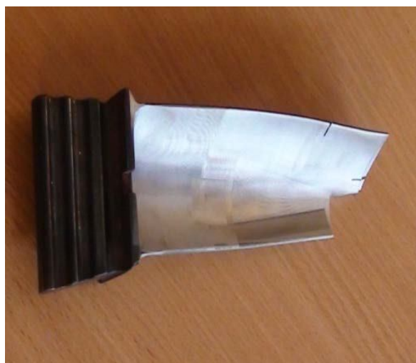
Рис. 3. Очистка турбинных лопаток от эксплуатационных загрязнений. Очищенная лопатка
