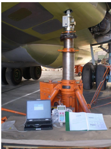
Рис. 3. Взвешивание самолета Ил-76 на стоечных авиационных весах ВАТ-130Р
