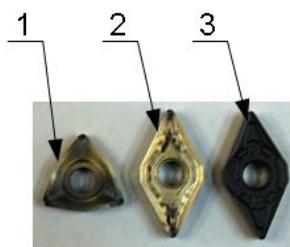
Рис. 1. Внешний вид пластин: 1 – из ВК8, 2 – Сандвик Коромант (Н13) и покрытие 0,2 HfN + 0,8 ZrN, 3 – Сандвик Коромант с двухслойным покрытием Al 2 O 3 + 0,2 HfN + 0,8 ZrN
