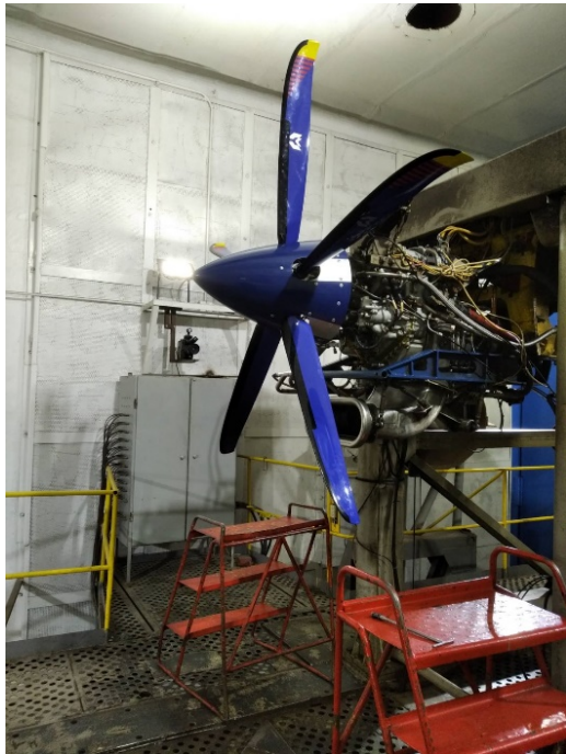
Рис. 1. Воздушный винт AI-P500V5 на испытательном стенде ГП «Ивченко-Прогресс»
