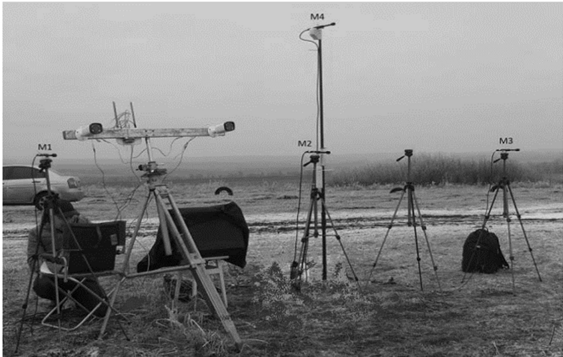
Рисунок 2.19 – Мікрофонна решітка M_1 - M_4 пасивного содара
