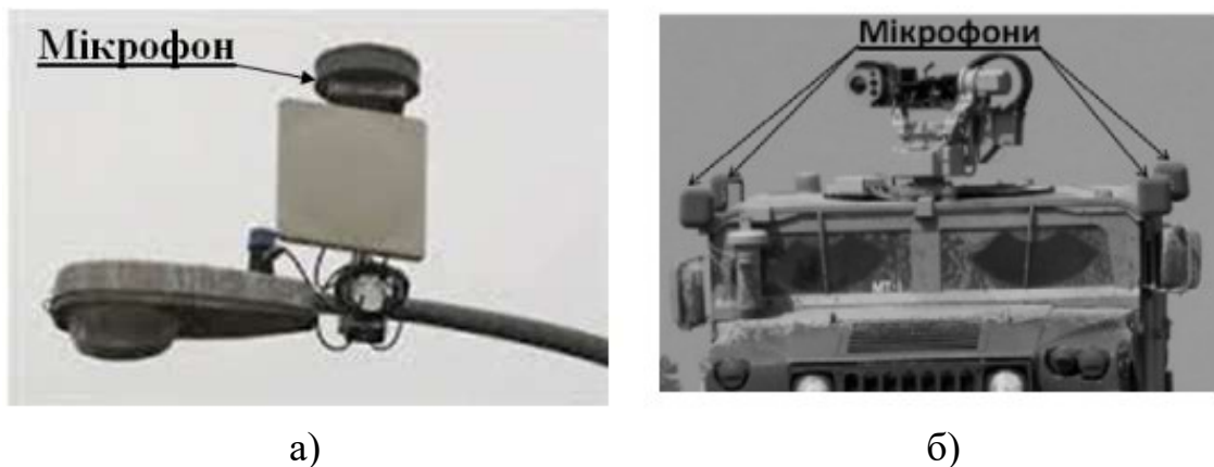
Рисунок 1.5 — Приклад стаціонарної (а) та мобільної (б) акустичної системи виявлення
