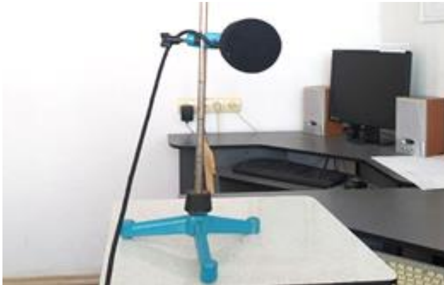
Рисунок 2.9 – Вимірювальний мікрофон ВПМ-101 на стійці, що регулюється
