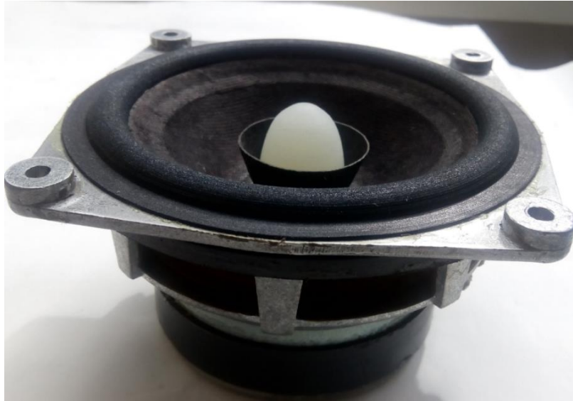
Рисунок 2.6 – Гучномовець 15ГД-11 Б з фазо корегувальною кулею
