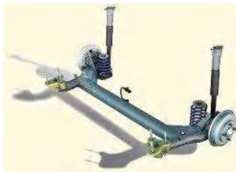
Рисунок 1.7 – Напівнезалежна задня підвіска
