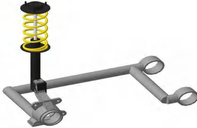
Рисунок 1.2 – Незалежна підвіска на поздовжніх важелях
