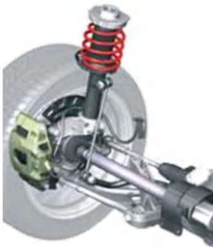
Рисунок 1.3 – Незалежна підвіска типу МакФерсон
