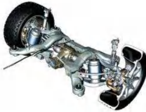
Рисунок 1.6 - Підвіска типу "Де Діон"
