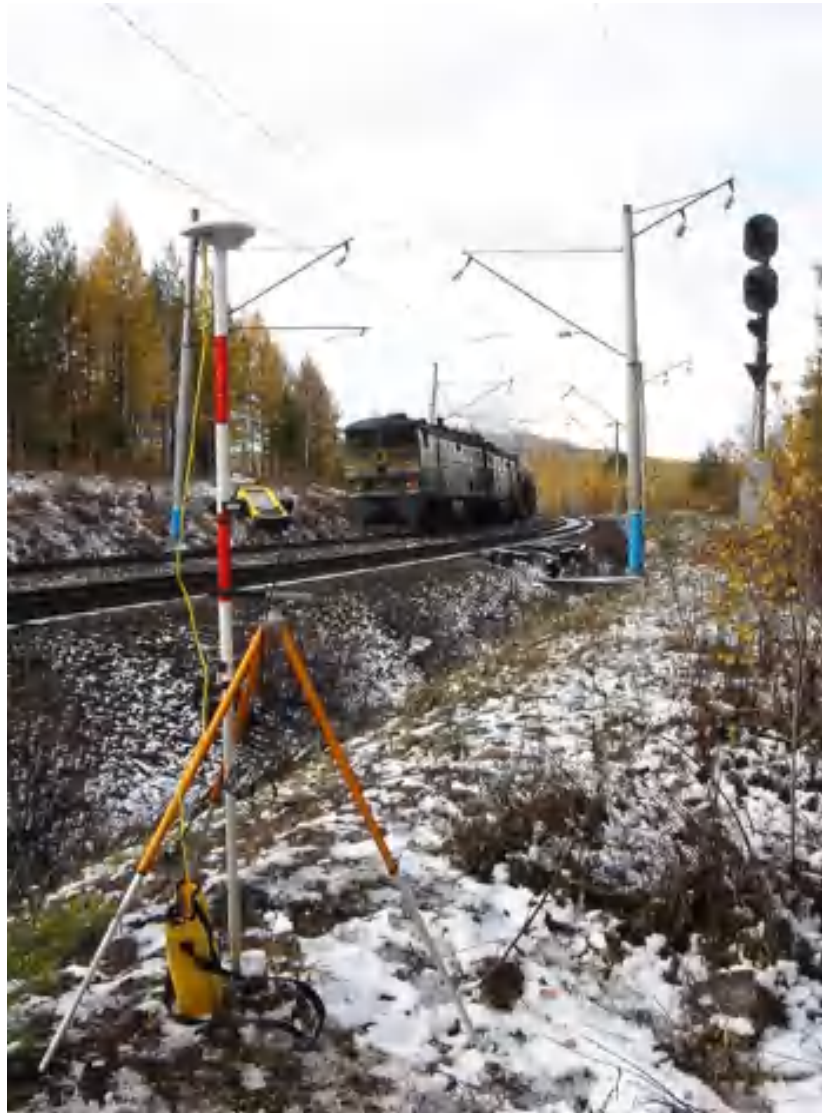
Рисунок 2.6 – GNSS-приймач на підставці-триподі у режимі статичних вимірів (базова станція)
