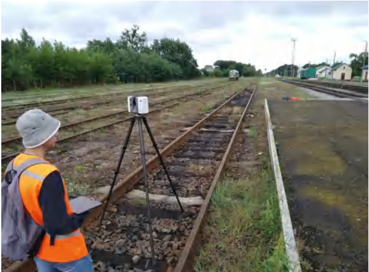
Рисунок 2.7 – Наземний лазерний сканер Leica RTC 360 у процесі сканування залізничного вузла
