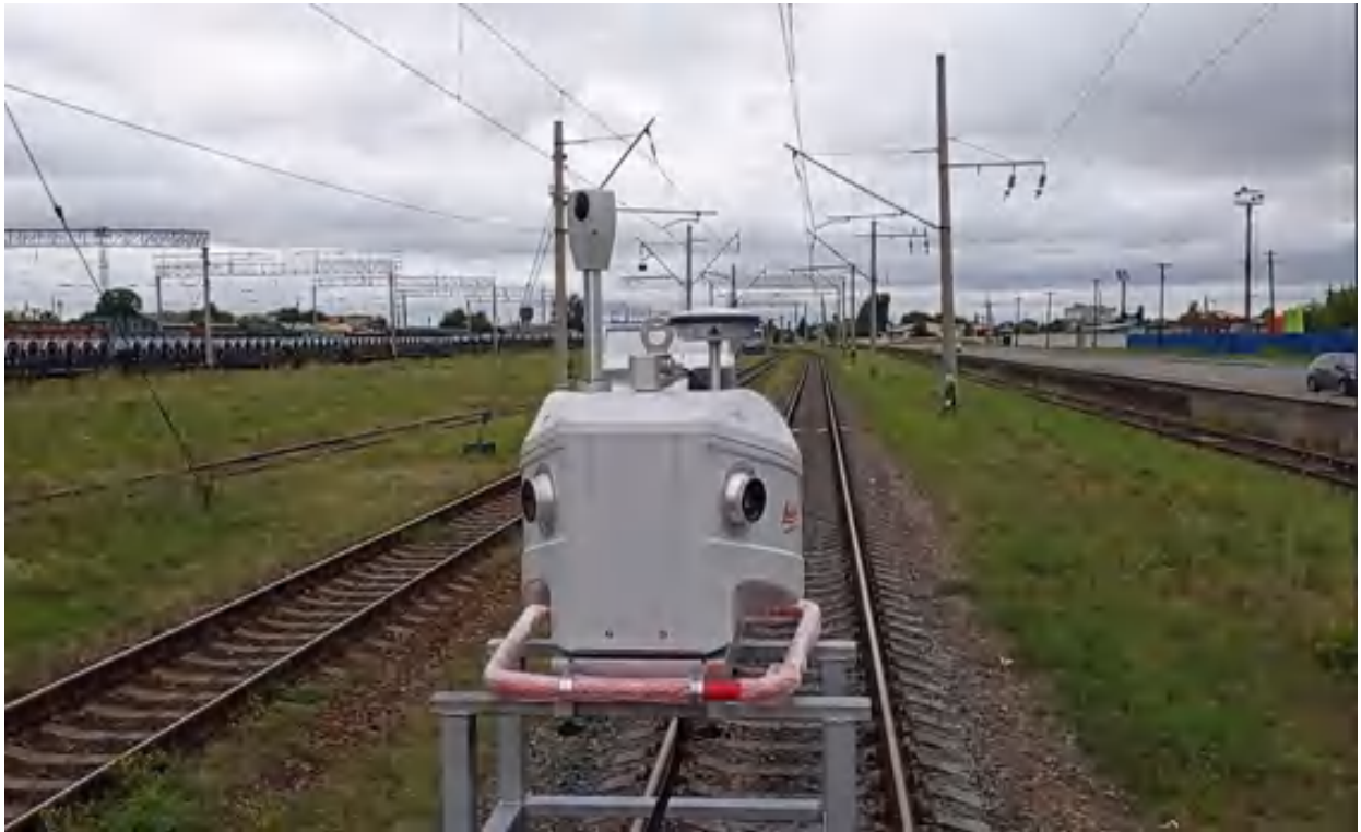
Рисунок 3.6 – Система МЛС Leica Pegasus Two: Ultimate в процесі сканування залізничного прогону Ковель – Мацеїв
