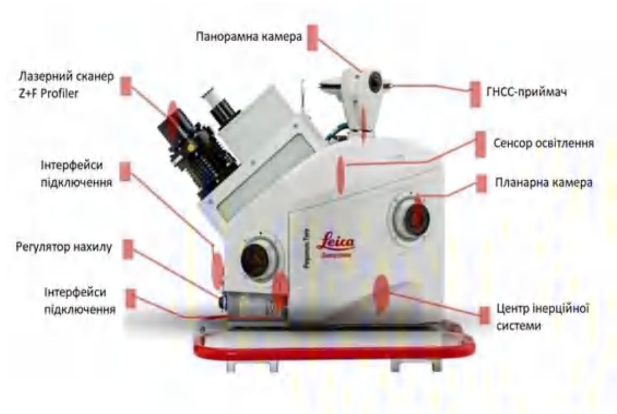
Рисунок 2.9 – Складові системи МЛС Leica Pegasus Two: Ultimate
