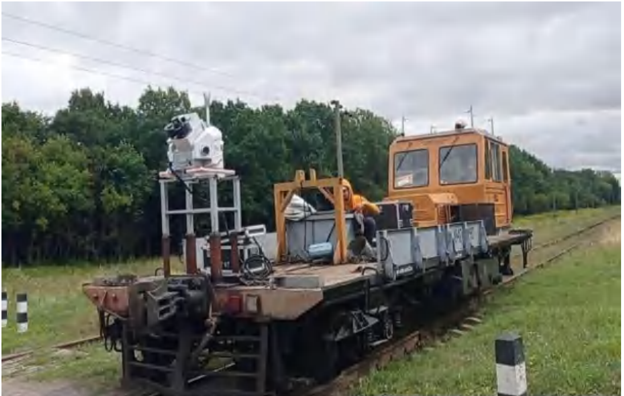
Рисунок 3.6 – Залізнична дрезина зі встановленою системою мобільного лазерного сканування Leica Pegasus Two: Ultimate
