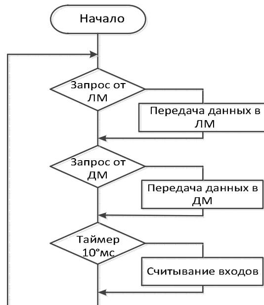
Рис. 1. Алгоритм программы модуля ввода дискретных сигналов
