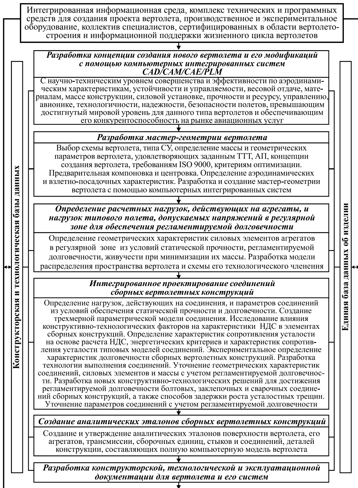
Рис. 2. Новая концепция интегрированного проектирования сборных вертолетных конструкций
