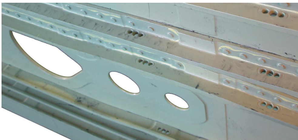
Рис. 5. Фрагмент растянутой панели крыла с вырезом под установку блока топливных насосов и отверстиями для перетекания топлива
