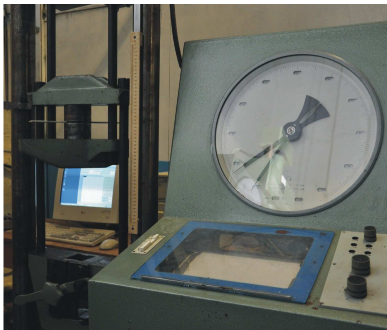
Рис. 4. Установка образца для выполнения совместного локального и барьерного обжатия полосы в зоне цилиндроконического отверстия на установке ZD 10/90
