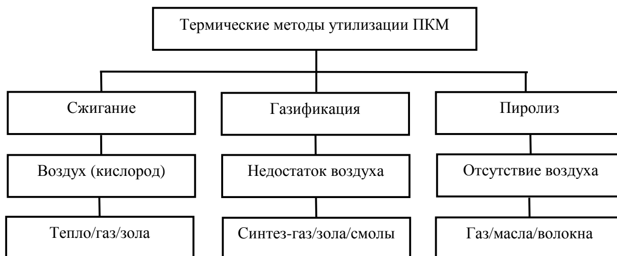
Рис. 4. Особенности и продукты термических методов утилизации ПКМ
