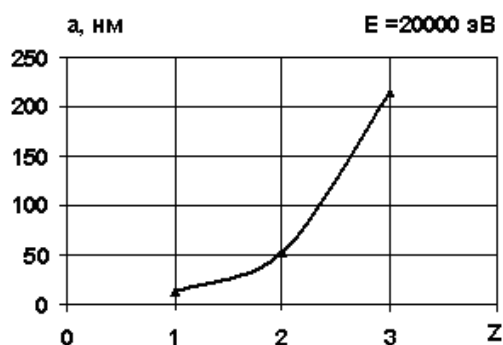
Рис. 3. Зависимость размера зерна от заряда ионов Al при энергиях 2 \cdot 10^2 , 2 \cdot 10^3 (а) и 2 \cdot 10^4 эВ (б)
