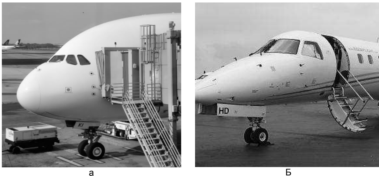
Рис 9. Дверь пассажирской кабины: а - пассажирский самолет А380; б - административный самолет ЕМВ-135
