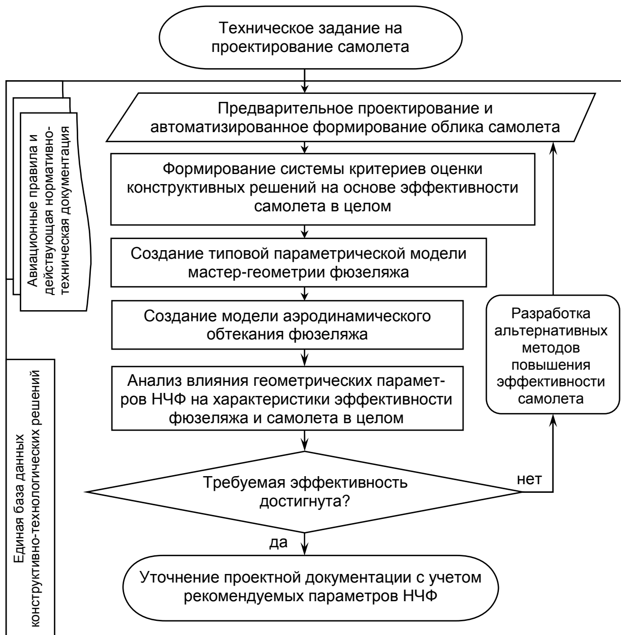
Рис. 1. Схема метода интегрированного параметрического анализа влияния геометрических параметров носовой части фюзеляжа на характеристики эффективности самолета транспортной категории
