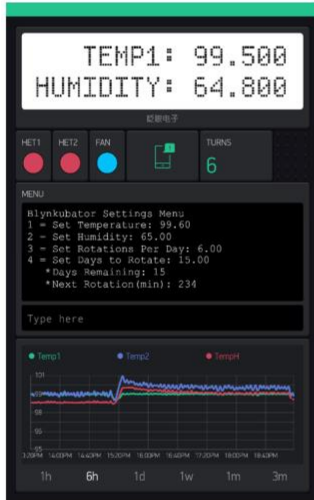
Рис. 11. Скрін службової програми для потокового контролю засобами персонального зв'язку (смартфоном) з використанням системи NodeMCU [21 – 24]
