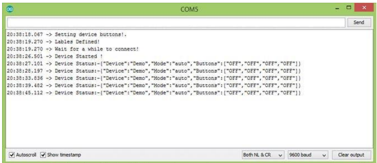
Рис. 43. Перевірка правильності комутації елементів
