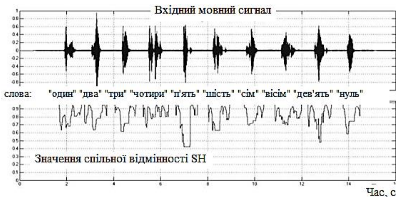
Рисунок 2.16 – Графіки вхідного сигналу та величини різниці від шаблону після застосування відносної міри та нелінійності. Вхідний сигнал з файлу №2
