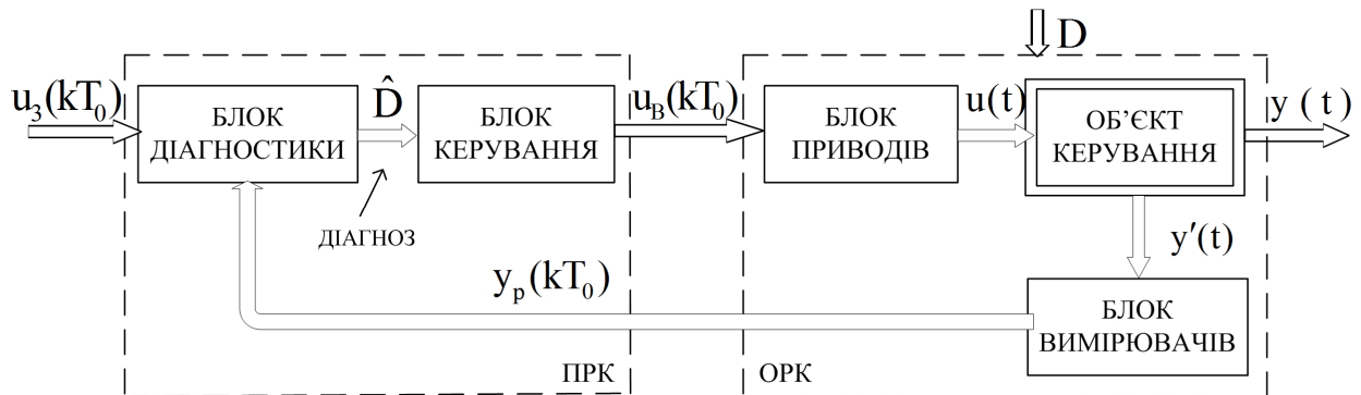
Рисунок 1.1 – Блок-схема раціональної системи керування за діагнозом
