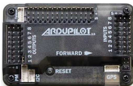
Рисунок 3.2 – Польотний контролер ArdupilotMega2.6
