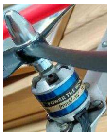
Рисунок 3.7 – Безколекторний двигун BL 2215/20
