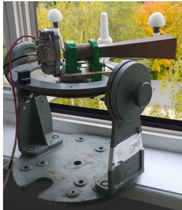
Рис. 1. Загальний вигляд дослідного зразка мікрохвильового радара
