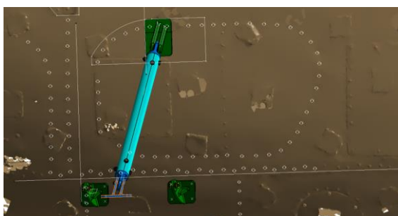
Рис. 5. Елементи кріплення радару на відсік Ф1 вертольота Мі-8МСБ1
