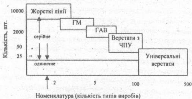
Рис. 3.4. Сфера використання типів виробництв і засобів виробництва: ГМ - гнучкі модулі; ГАВ - гнучке автоматизоване виробництво
