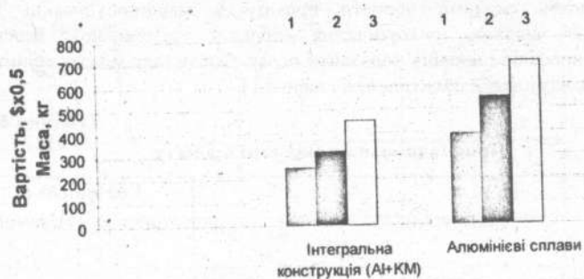
Рис. 4.4. Вартість маси планера літака: 1 - вартість виробництва; 2 - вартість матеріалів; 3 - маса
