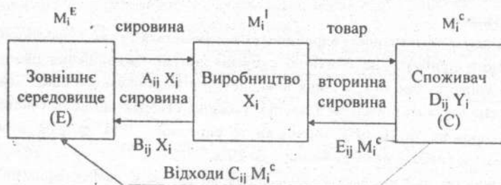
Рис. 4.1. Модель потоків матеріалів у системі: виробництво (I) – споживач (C) – зовнішнє середовище (E): M_i^E - маса матеріалу у зовнішньому середовищі; M_i^I - маса матеріалу у виробництві; M_i^C - маса матеріалу у сфері споживача; A_{ij} - маса сировини на одиницю продукції; B_{ij} - маса матеріалу у зовнішньому середовищі; D_{ij} - маса одиниці продукції у споживача; C_{ij} - маса відходів від споживача на одиницю маси матеріалу у споживача (на звалище); E_{ij} - маса вторинних матеріалів, направлених у виробництво, на одиницю маси матеріалу у споживача; X_{ij} - число одиниць продукції k -го типу, вироблених в одиницю часу; Y_{ij} - число одиниць продукції k -го типу, що знаходиться у споживача в одиницю часу
