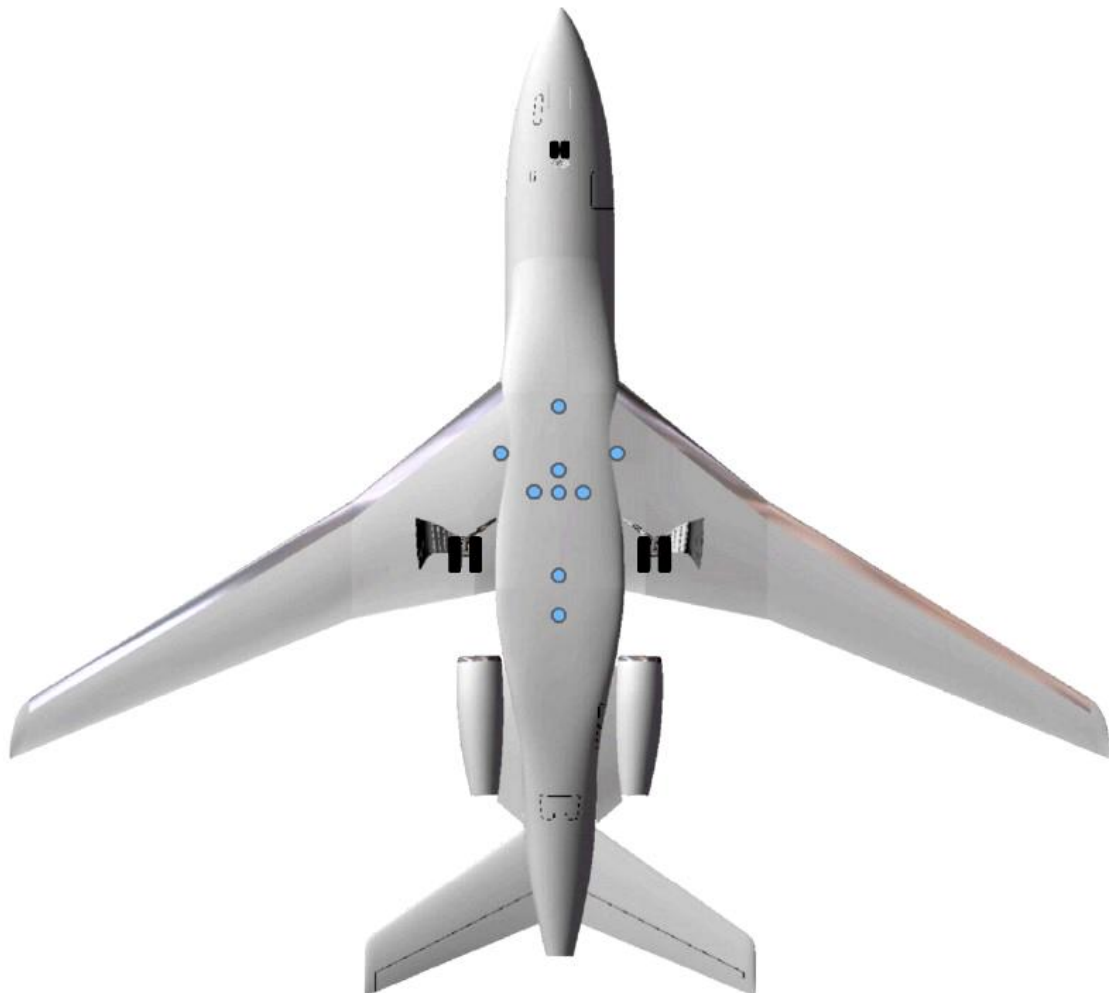
Рисунок 2.3 - Схема розташування клапанів зливу
