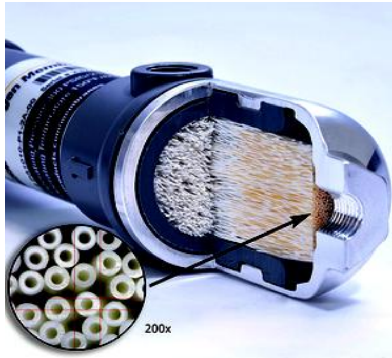
Рисунок 2.20 - Мембранний модуль в розрізі
