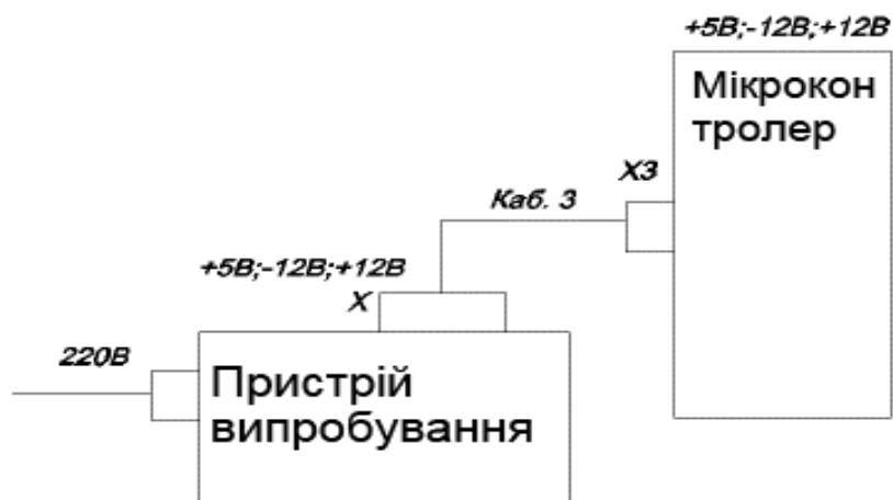
Рисунок 4.4 – Схема з'єднання діагностування несправності модуля керування ШВЛ
