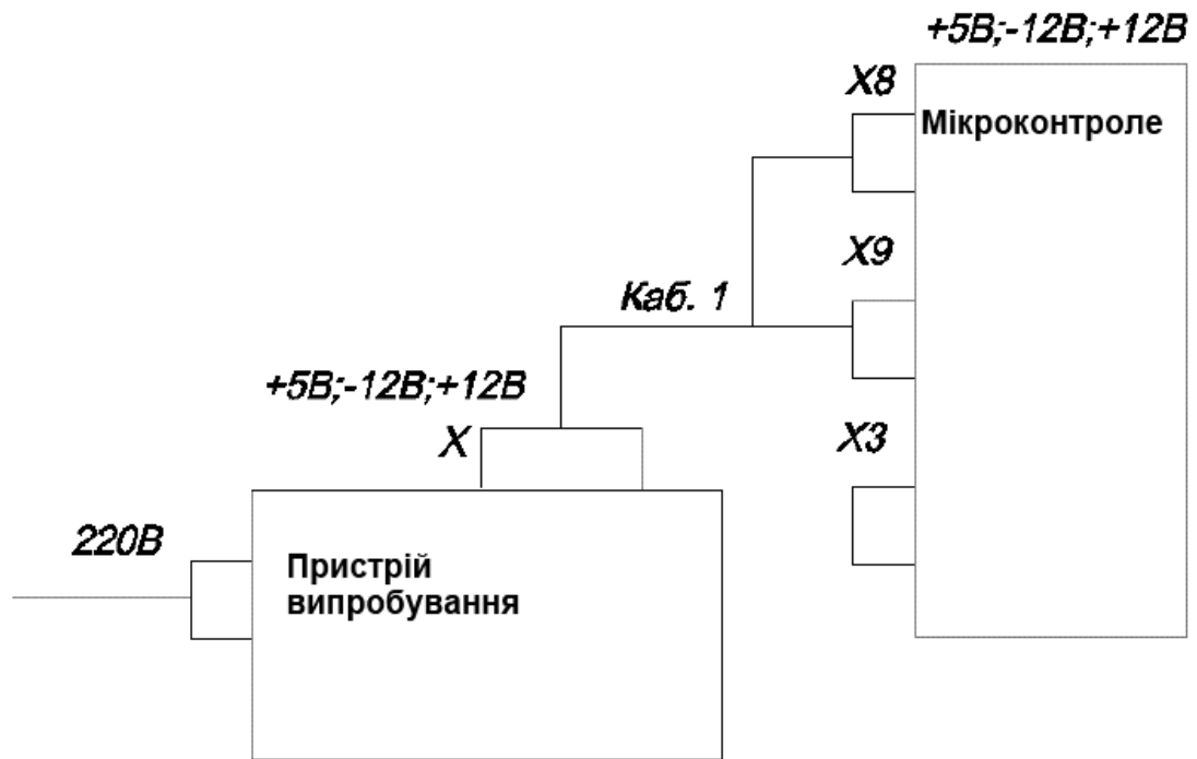
Рисунок 4.2 – Схема з'єднання постійного ПЗПІ в динамічному режимі
