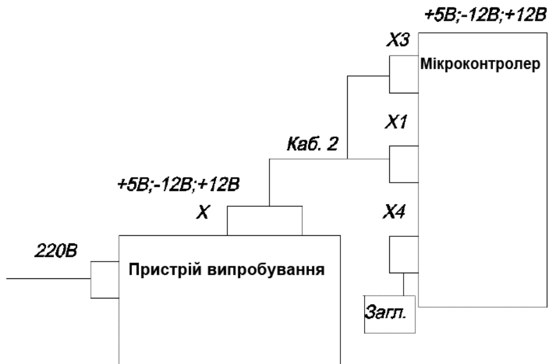
Рисунок 4.3 – Схема з'єднання запам'ятовуючого пристрою ПЗП
