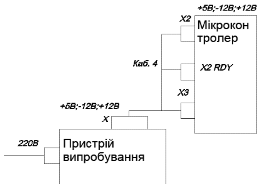
Рисунок 4.5 – Схема з'єднання в статичному режимі
