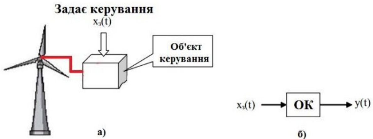
Рисунок 4.1 – Вітрогенератор (а) і відповідна структурна схема (б)
