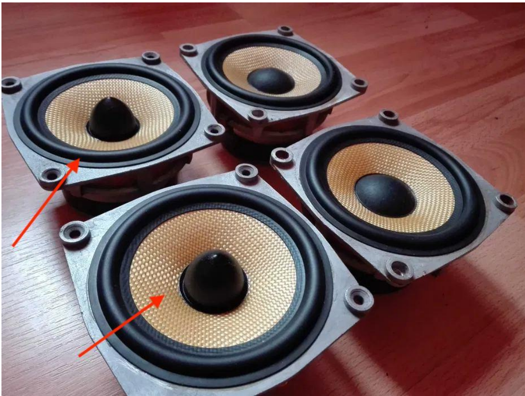
Рисунок 1.14 – Середньочастотний динамік з дифузором-пулею та динамік звичайної конструкції
