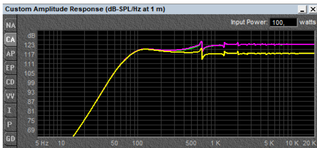
Рисунок 3.14 - Залежність максимального амплітудного відгука сабвуфера акустичного оформлення «фазоінвертор» від форми корпусу
