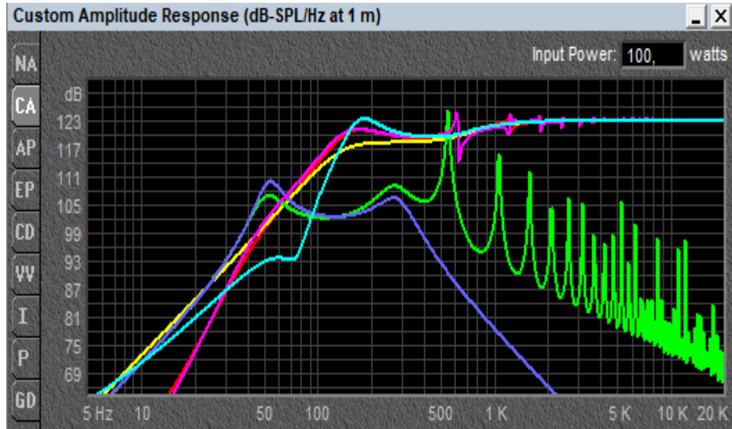
Рисунок 3.38 - Залежність максимального амплітудного відгука сабвуфера форми корпусу «призма» об'ємом 20 л від акустичного оформлення
