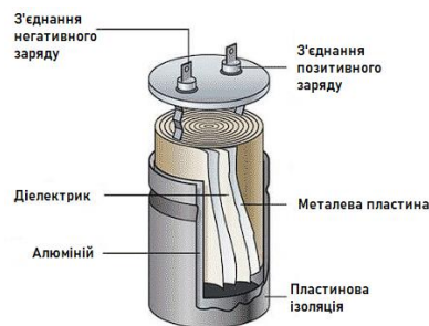
Рисунок 1.20 – Будова електролітичного конденсатора
