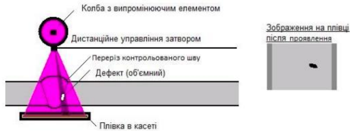
Рисунок 1.16 – Схема гамаграфічного методу
