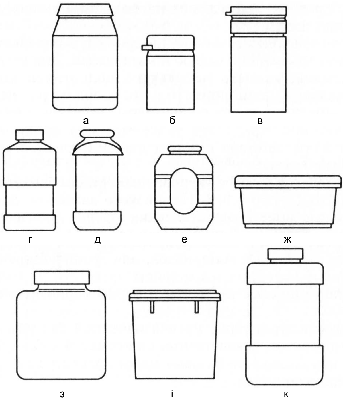
Рисунок 2.1 — Маркування типів полімерних банок (БН): а — I-2-3; б — I-2-4; в — I-2-5; г — II-1-7; д — II-2-8; е — IV-2; ж — III-2-12; з — I-1-1; і — III-2-10; к — I-1-2
