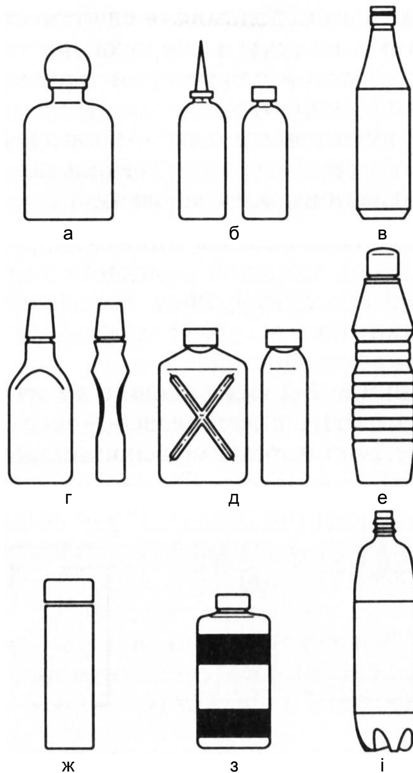
Рисунок 2.2 — Маркування типів полімерних пляшок (БТ): а — І-1-18; б — ІІІ-1-26; в — І-1-21; г — І-1-19; д — ІІ-1-23; е — І-1-22; ж — І-1-20; з — ІІІ-1-24; і — ІІІ-1-25
