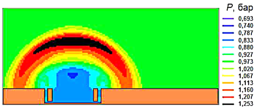
Рис. 7.46. Розподіл тиску в момент часу 0,0158 мкс після вибуху (V6)
