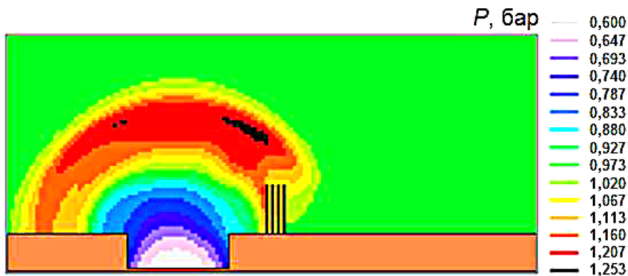
Рис. 7.50. Розподіл тиску в момент часу 0,0158 мкс після вибуху (V8)
