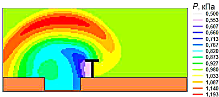
Рис. 7.52. Розподіл тиску в момент часу 0,023 мкс після вибуху (V10)
