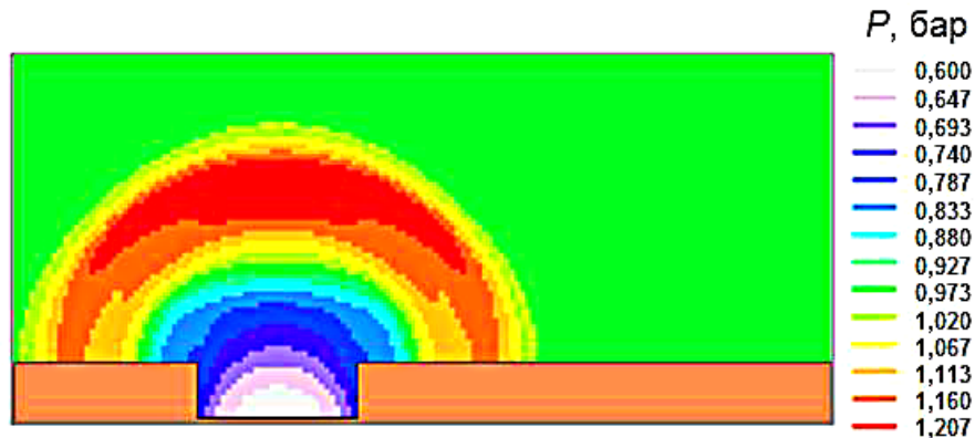
Рис. 7.44. Розподіл тиску в момент часу 0,0157 мкс після вибуху (V5)
