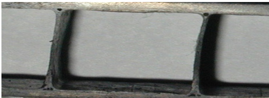
Рисунок 1 - Трубчатая конструкция с воздушными включениями в местах стыков
