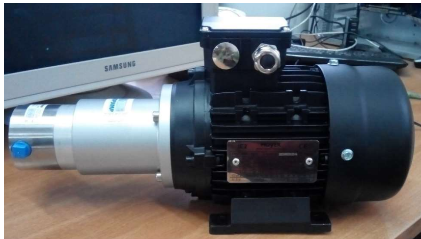
Рисунок 7- Насос для роботи в агресивному середовищі. фірма Нoyer Туре
