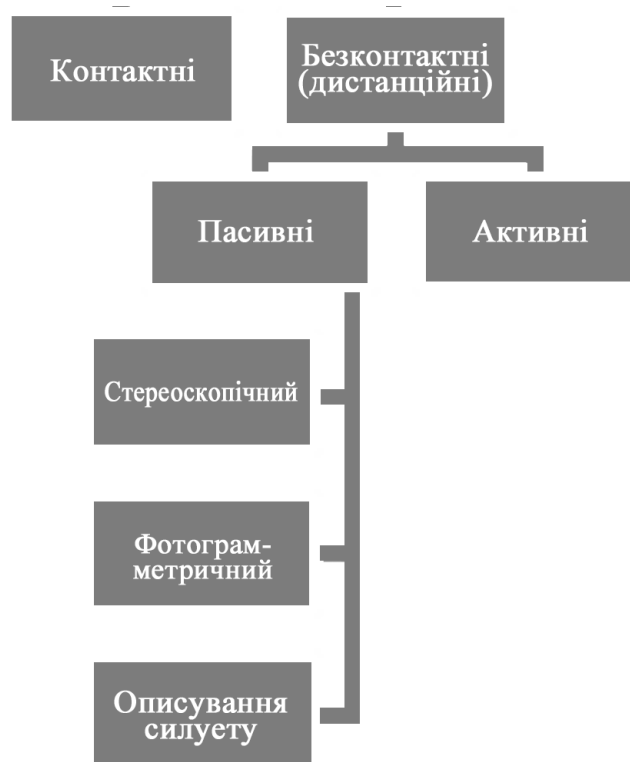
Малюнок 1.7 - Класифікація 3D-сканерів за технологією сканування
