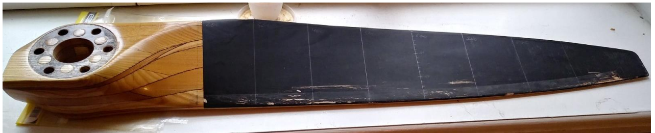
Мал. 5.1- Частина дерев'яного повітряного гвинта надлегкого літака
