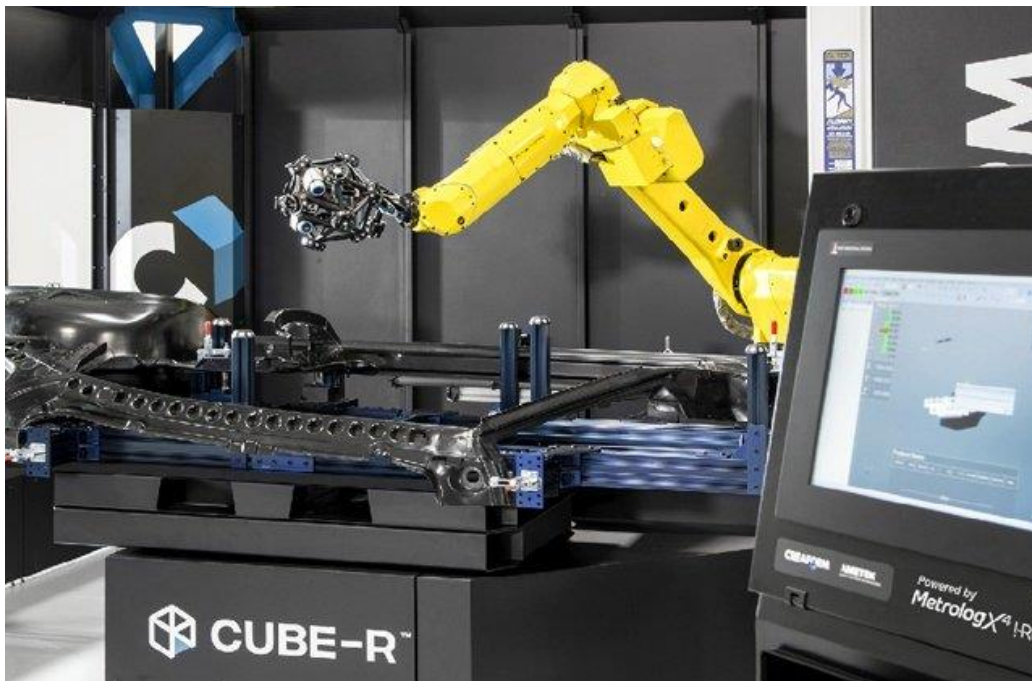
Мал. 2.9– Процес сканування зі застосуванням механічної руки (маніпулятора)
