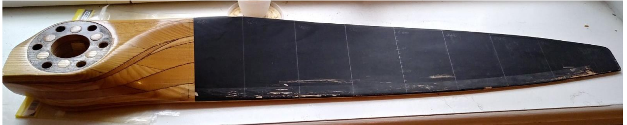
Мал. 1.2– Реальна частина лопаті гвинта
