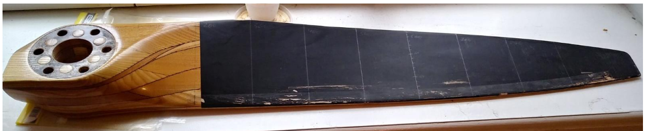
Мал. 1.10- Частина дерев'яного повітряного гвинта надлегкого літака
