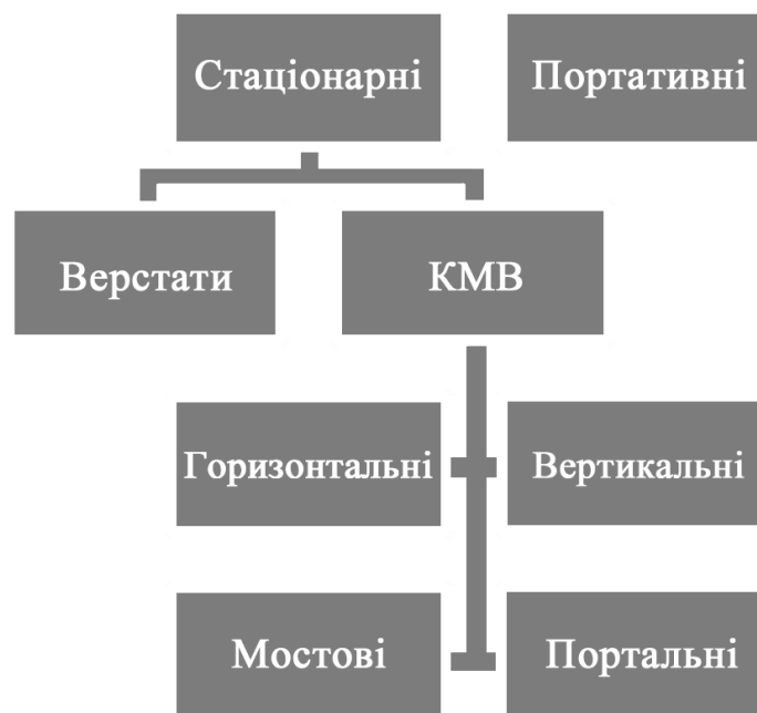
Малюнок 1.6 - Класифікація 3D-сканерів за способом встановлення
