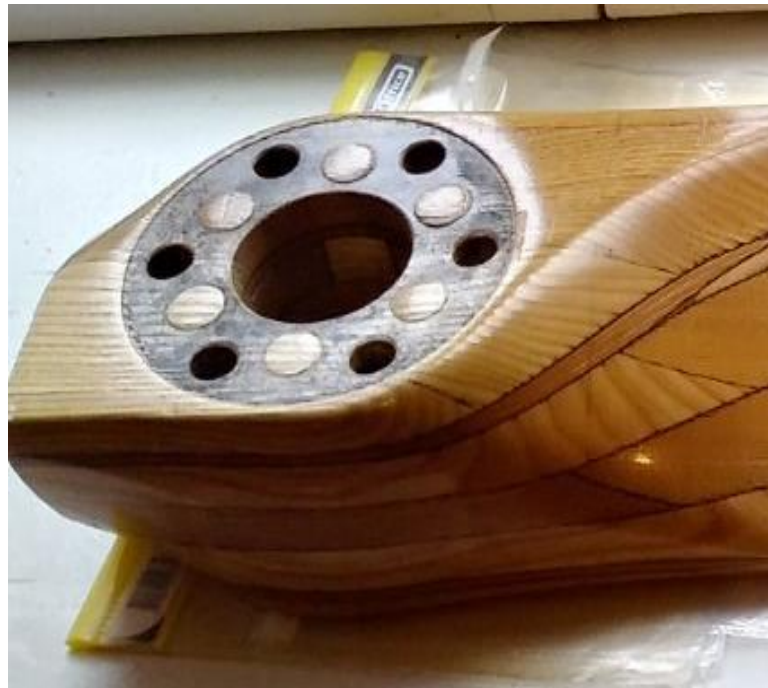
Мал.3.7–Дефект ступиці гвинта внаслідок перебільшення зусилля затягування з'єднання типу болтового
