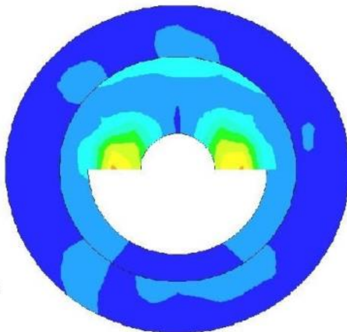
Рисунок 2.17 – Епюра швидкостей гідрогенератора СГКЗ 538/160-70 (косий перетин відносно міжполюсного каналу ротора (перетин А-А))
