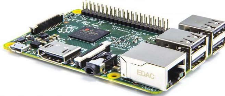
Рисунок 2.1 – Мікрокомп'ютер Raspberry Pi 3B
