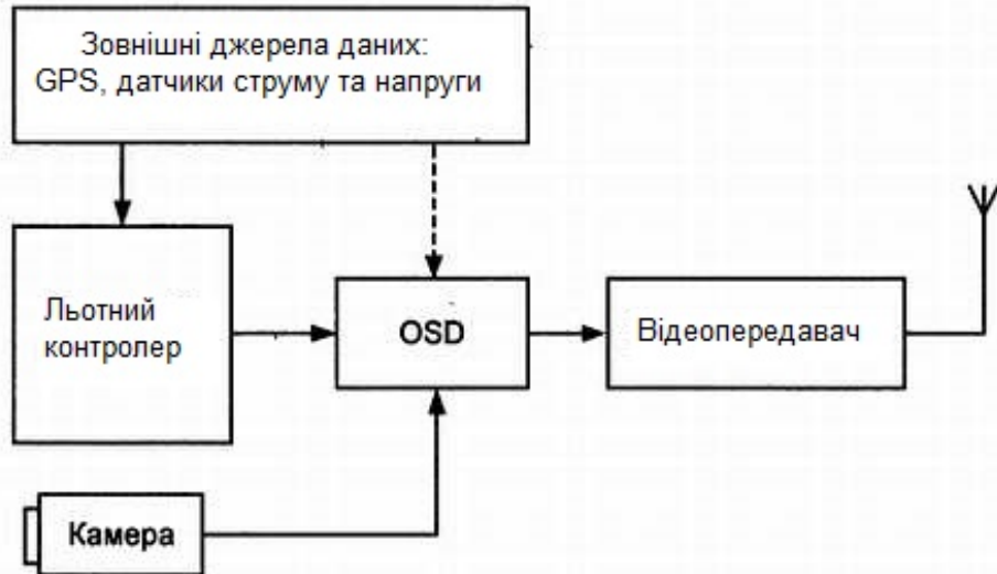
Рисунок 3.19 – Структурна схема застосування телеметрії з OSD
