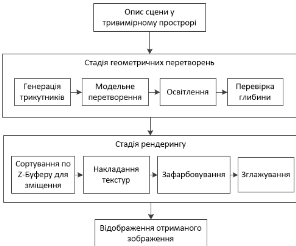
Рисунок 1.1 – Схема роботи конвеєру рендеру
