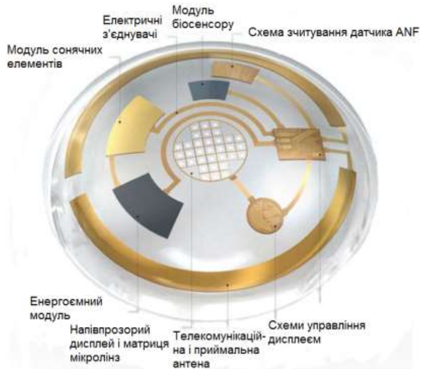
Рисунок 1.8 - Схема розумної контактної лінзи
