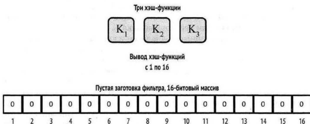
Рисунок 2.5 – Приклад спрощеного фільтра Блума з 16-бітовим масивом і трьома хеш функціями
