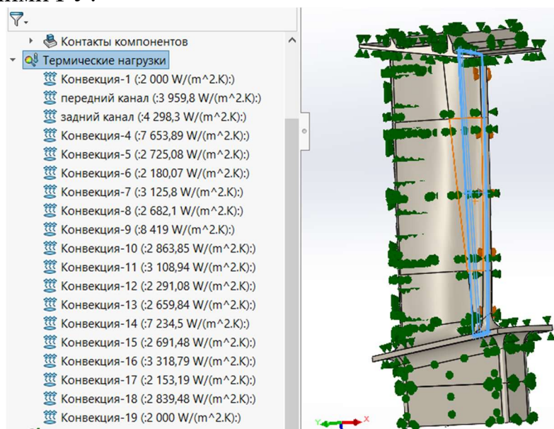
Рисунок 2.22 Граничні умови на поверхні лопатки та всередині каналів охолодження
