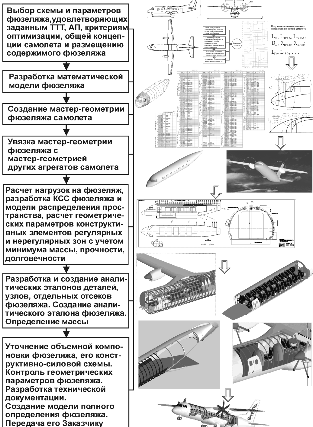
Рис. 7. Интегрированный метод проектирования и компьютерного моделирования фюзеляжа при помощи систем CAD/CAM/CAE
