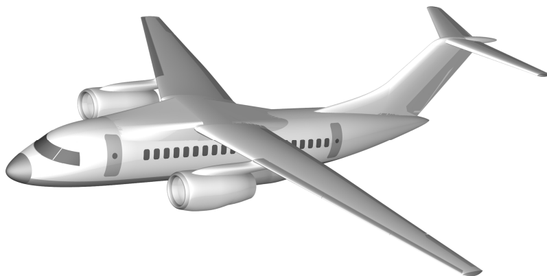
Рис. 2. Мастер-геометрия (модели поверхностей) самолетов, созданных при помощи системы CAD\CAM\CAE UNIGRAPHICS: а – Ан-140; б – Ан-74ТК-300; в – Ан-148
