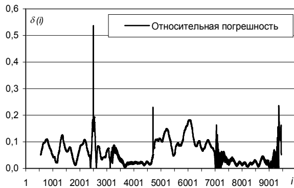
Рис. 10. Относительная погрешность измерений после обработки медианно- \alpha -урезанным ЛАФ с дополнительным \alpha -урезанным фильтром и пост-обработкой сигма фильтром при применении преобразования Энскомба
