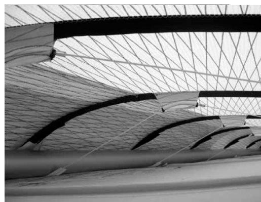
Рис. 8. Фрагмент механизма управления толщиной профиля дельтаплана Revolution австралийской фирмы Airborne
