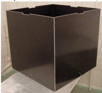
Рис. 1. Несущая конструкция теплового экрана КА «Січ-2»
