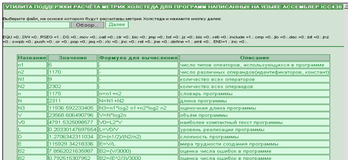
Рис. 2. Интерфейсное окно утилиты поддержки расчёта метрик Холстеда
