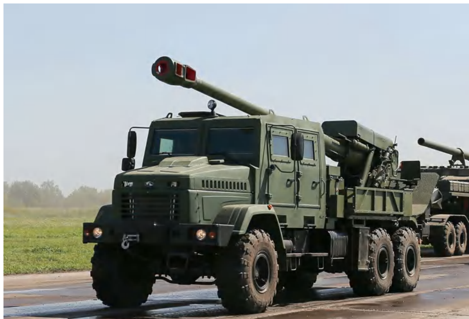
Рисунок 2.1 – Загальний вигляд колісної самохідної гаубиці 2С22 «Богдана» на базі колісного шасі КрАЗ-63221
